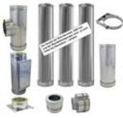
bestehend aus: 1 Stück Mündungsbausatz, 7 Stück Rohrelement 1000 mm, 1 Stück Rohrelement 500 mm, 1 Stück Feuerungsanschluss 90°, 1 Stück Kupplung EW/DW, 1 Stück Revisionselement, 1 Stück Verankerungsplatte isoliert mit Entwässerungsmuffe, 2 Stück Wandbefestigung starr 50 mm Wandabstand
