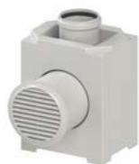
erforderlich bei Schachtlängen über 5 Meter, Länge: 250 mm, Tiefe: 150 mm, Breite: 200 mm (inkl. PPs-Abgasleitung D 80 und Lüftungsgitter)
